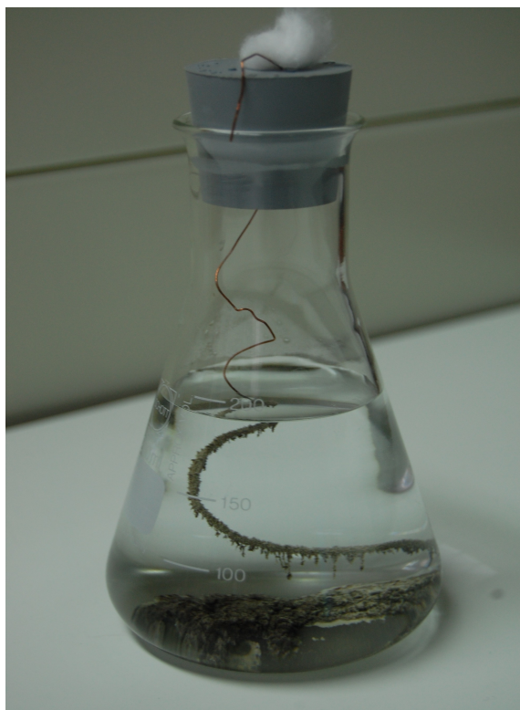
Fig.2 – Fio de cobre em solução aquosa de nitrato de prata, no fim da reação (produtos da reação).
