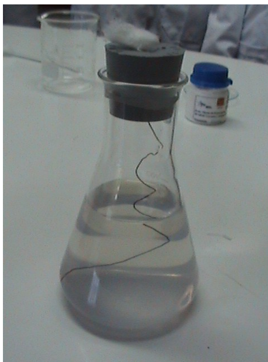
Fig.1 – Fio de cobre em solução aquosa de nitrato de prata, no início da reação (reagentes).
