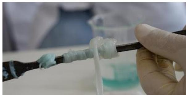
*A reação ocorre na interface dos dois solventes imiscíveis (polimerização interfacial) onde os dois monómeros se encontram dissolvidos, originando nylon 6.6 (esta numeração indica o número de átomos de carbono que os seus monómeros possuem, neste caso, como a diamina usada e o diácido apresentam igualmente 6 átomos de carbono, então o nylon é do tipo 6,6.)*
